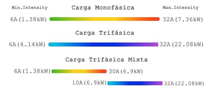
Los límites Min.Intensity y Max.Intensity hacen referencia a los límites de intensidad configurados en el menú del cargador a través de la aplicación.
